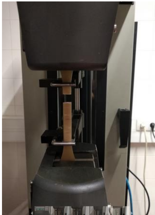
Figura 22 - Final do ensaio de tração de um provete de PP com carga de argila
