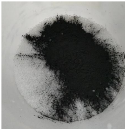
Figura 13 – PP com carga de grafite
