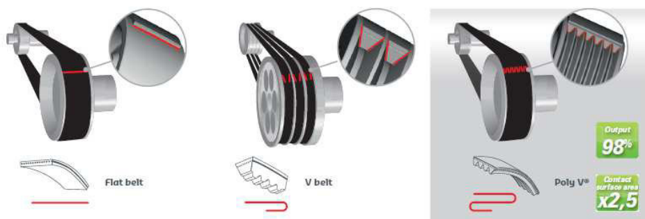
Figura 47 - Correias Poly-V ® com maior área de contato (Hutchinson 2014)
