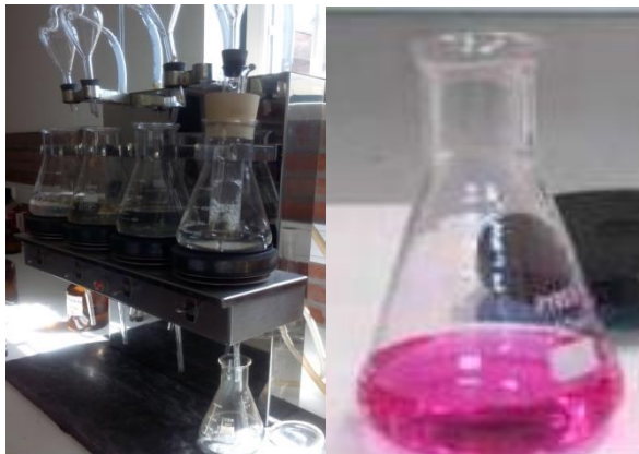
Figura 16 Equipamento utilizado no tratamento da amostra para determinação da acidez volátil e amostra após titulação (Imagem pessoal)
