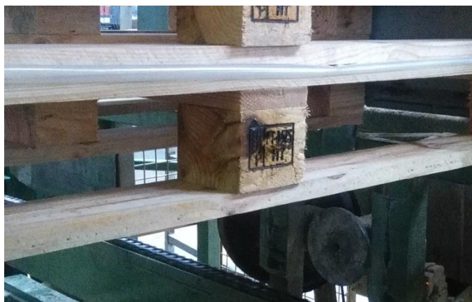
Figura 16: O carimbo de tratamento HT não está perceptível
