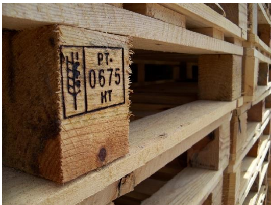
Figura 15: Carimbo de tratamento HT
