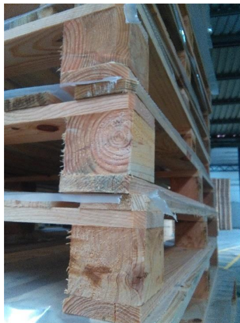
Figura 18: Falha no corte de canto
