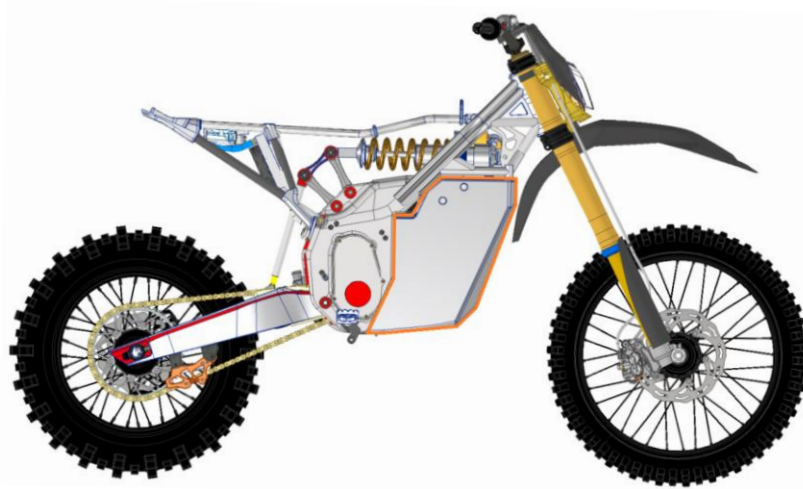
Figura 4.5 – Geometria do casing que contém os módulos aplicado no veículo
