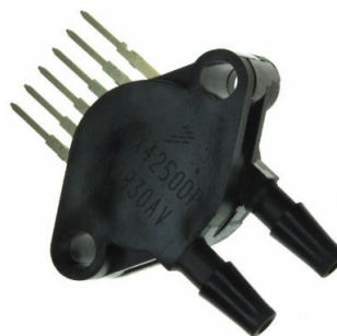
Figura 4.25 – Sensor de pressão diferencial MPX5010DP da marca NXP, adaptado de (DigiKey, 2024a)
