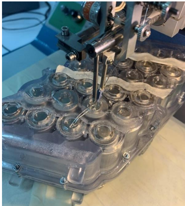
Figura 4.18 – Processo de soldadura wirebonding
