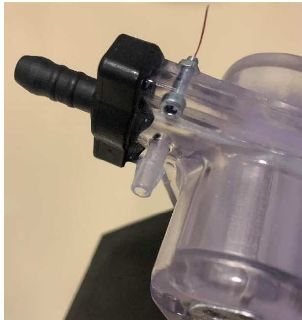
Figura 4.19 – Estrutura de tomada de pressão
