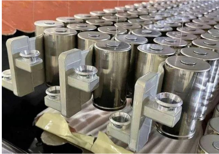
Figura 2.28 – Vista de detalhe dos pontos de entrada e saída de fluido, adaptado de (Battery Design, 2022)
