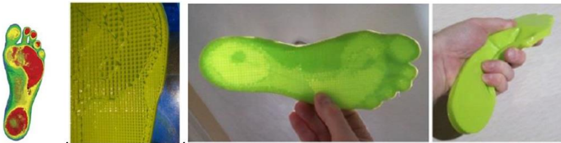
Figura 29: Processo de Fabrico da Palmilha através do método da Gyrobot , adaptado de Silva, 2015
