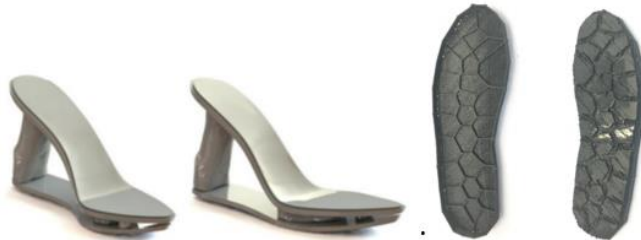
Figura 32: Sapatos impressos com TPU e TPE (tecnologia FDM), adaptado de Feijs et al., 2016; Spahiu et al., 2020
