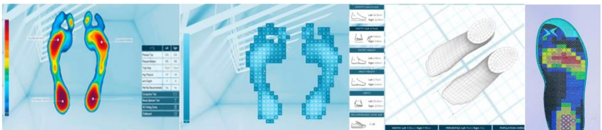
Figura 28: Processo de conceção da palmilha através do scanner da Aetrex's, adaptado de Schwartz & Tucker, 2021
