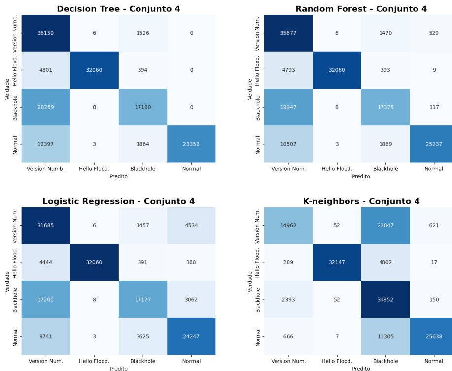
Figura 29: Matriz de confusão dos algoritmos aplicados ao dataset smart_greenhouse-multiclass com o conjunto de atributos número 4.
