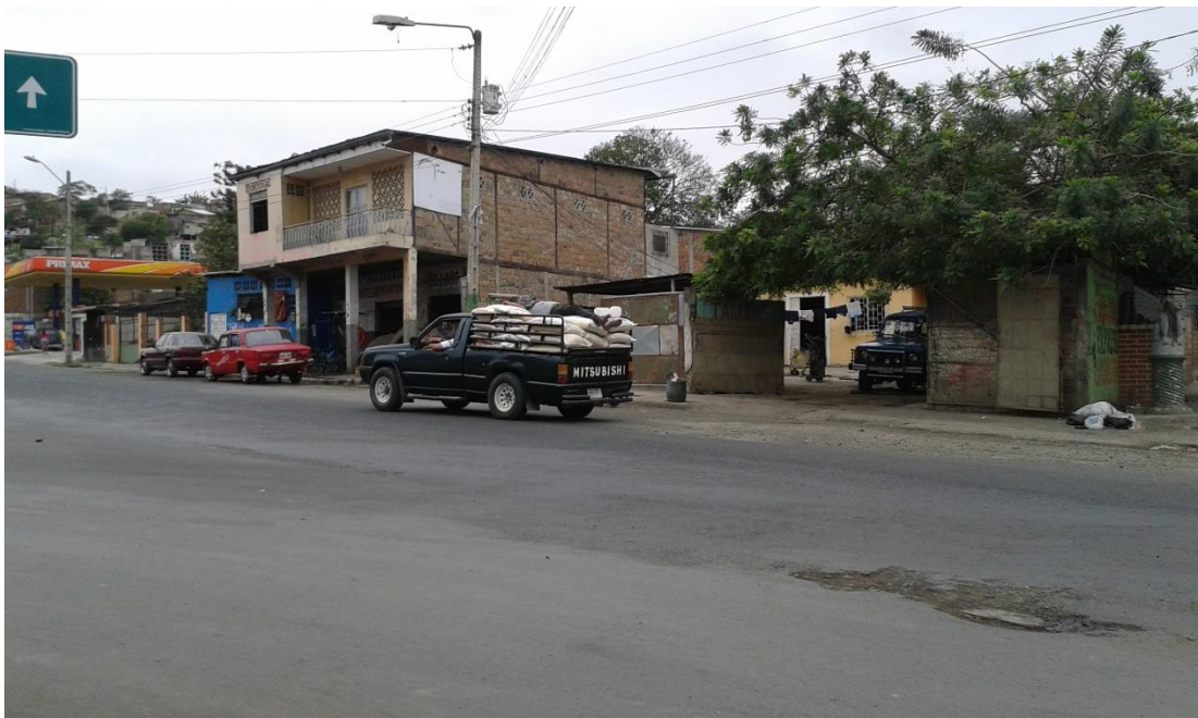
Figura 3.12: Vehículo liviano con exceso de carga, notorio asentamiento en eje trasero
