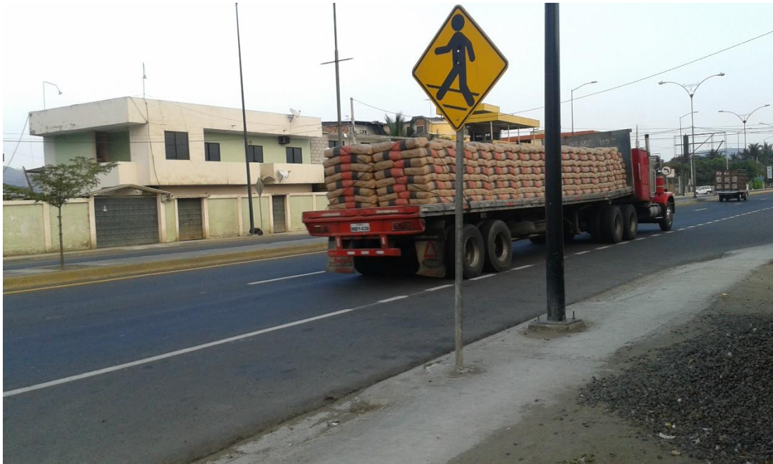
Figura 3.11: Transporte de carga pesada con 5 ejes (1 simple – 4 dobles)
