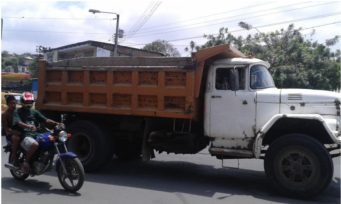
Figura 3.9: Volqueta con tablón en la parte del balde, con la finalidad de generar mayor volumen de transporte de carga que lo permitido
