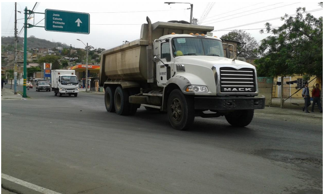
Figura 3.10: Volquetas con tres ejes (1 simple – 2 dobles)
