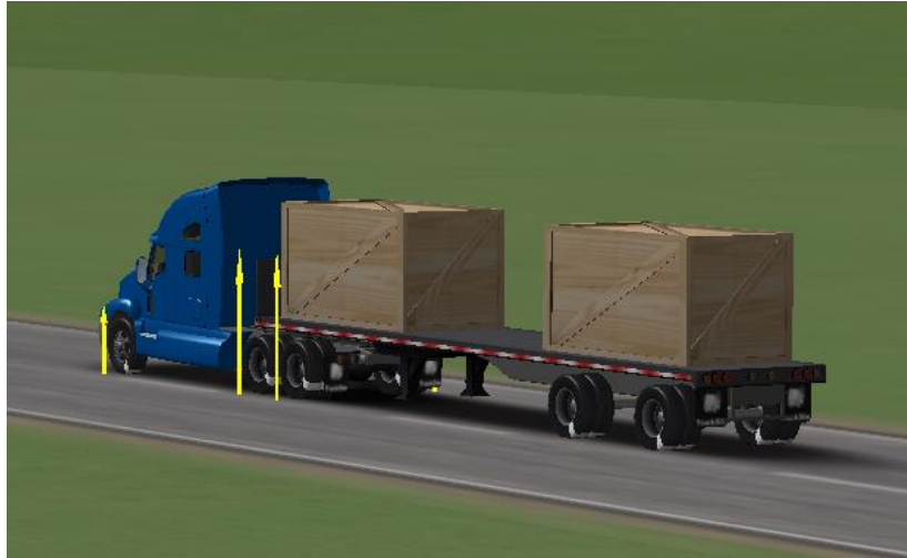
Figura 3.26: Vehículo que simula el tracto camión de 5 ejes (T3-S2)
