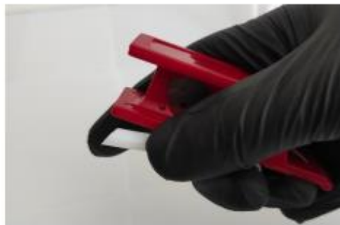
Figura 79 - Corte em cunha da extremidade do tubo a inserir no cárter
