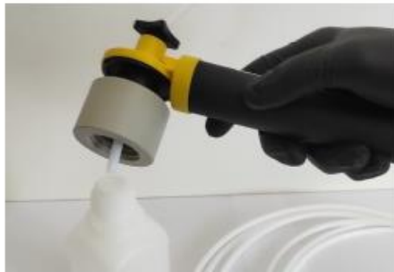
Figura 80 - Comprimento de segurança a deixar no interior do frasco de recolha
