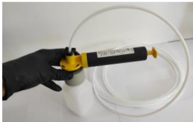
Figura 81 – Montagem da bomba de vácuo, frasco e tubo de recolha
