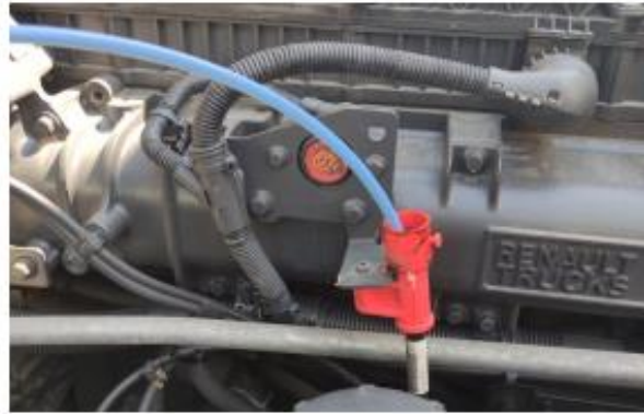
Figura 82 – Inserção do tubo de recolha no tubo da vareta de nível
