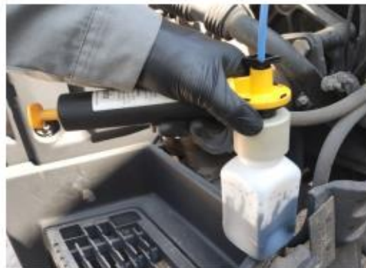
Figura 83 – Posição do frasco de recolha durante a realização da recolha
