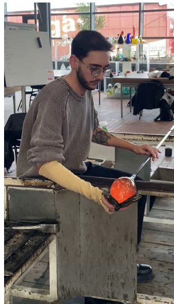
F117 - Glass Rope play - Conformação de bola de vidro Fotografia do autor
