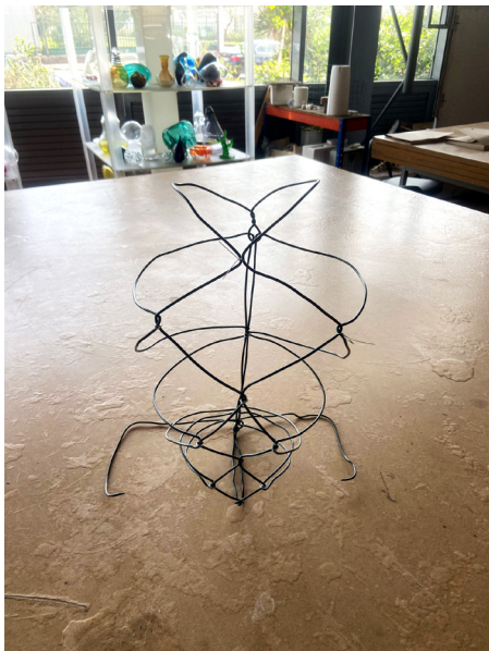
F116 - Estrutura em arame para produção de peças de vidro soprado Fotografia do autor
