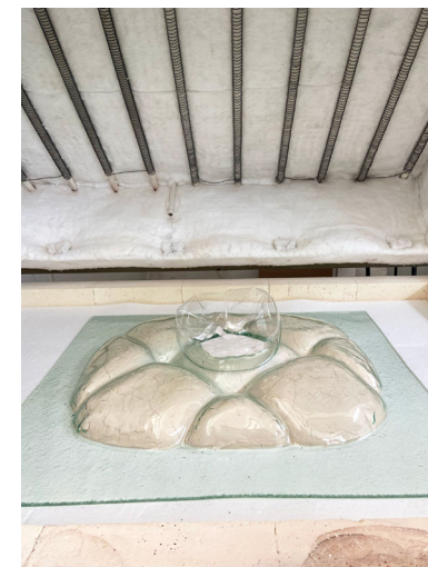
F125 - Primeiro teste de slumping Fotografia do autor
