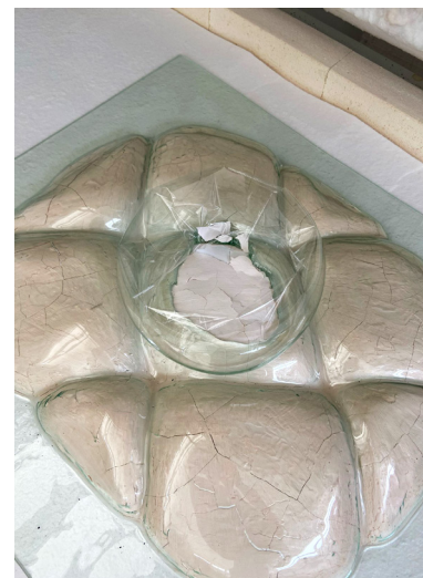
F126 - Detalhe da falha do teste de slumping Fotografia do autor
