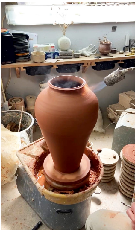
F75 - Secagem controlada através do uso de maçarico Fotografia do autor
