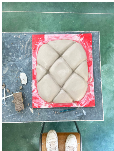
F122 - Peça esculpida em faiança, para produção de um molde em gesso Fotografia do autor
