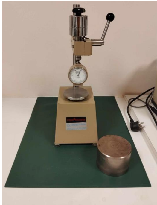
Figura 19 – Equipamento utilizado para o ensaio de dureza Shore D.
