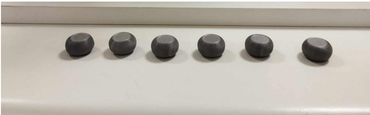
Figura 23 – Provetes de PLA após a realização do ensaio de compressão.
