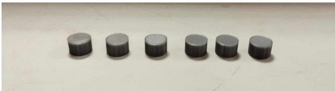
Figura 31 - Provetes de PLA utilizados para a realização do ensaio de abrasão
