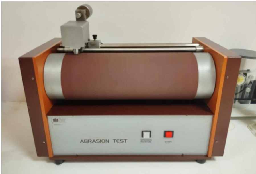
Figura 20 – Equipamento para a realização do ensaio de abrasão.
