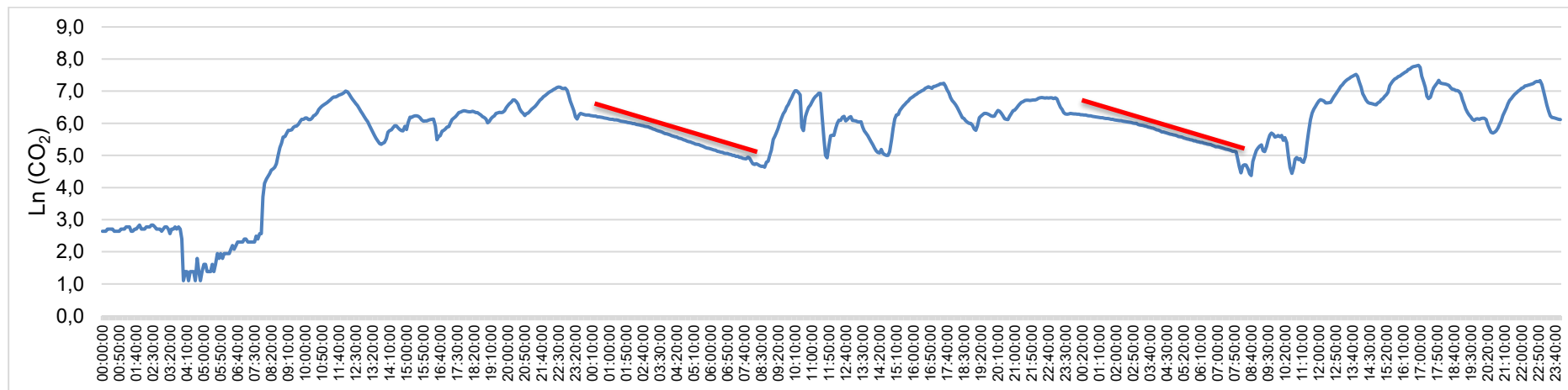
Figura 13 - Curvas de decaimento logarítmico do CO 2 utilizadas no cálculo da taxa de renovação do ar (AER). Período de 2024.
