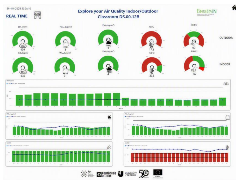
Figura 36 - Representação em tempo real com indicadores e séries temporais por minuto de CO 2 , PM 2.5 , PM 10 , temperatura do ar (°C) y humidade relativa do ar (HR), distinguindo entre ambientes interior e exterior.
