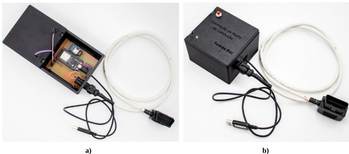
Figura 3-12 – Protótipo final do sistema de aquisição e registo de dados: a) vista interior e b) vista exterior
