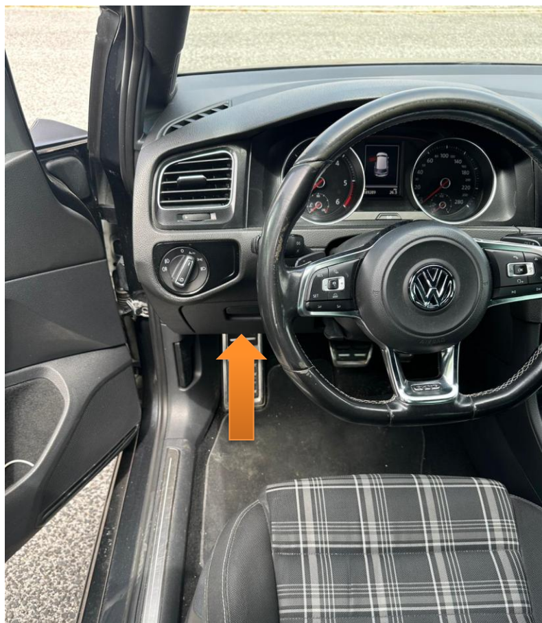
Figura 1 – Localização do conector OBD-II no veículo de teste
