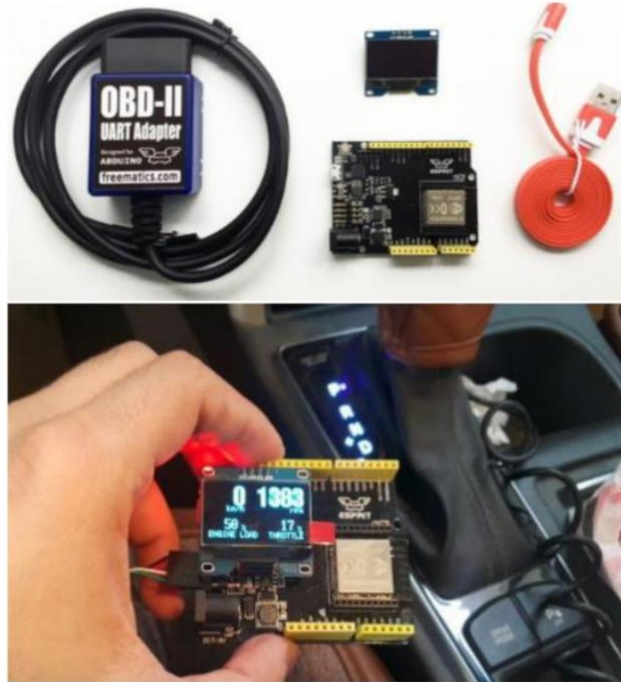
Figura 2-1 – Sistema de aquisição de dados desenvolvido por [17]
