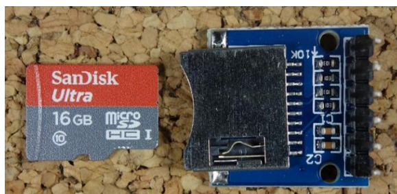
Figura 3-6 - Cartão microSD de 16GB e respetivo módulo
