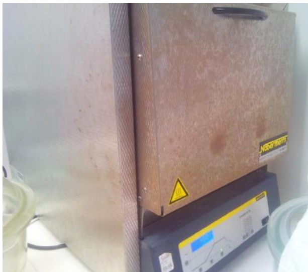
Figura 7.1.10 – Mufla (Controller B170, Nabertherm).
