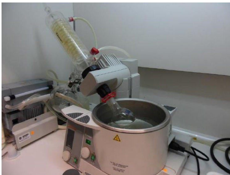
Figura 7.1.8 – Evaporação do éter no evaporador rotativo (Laborota 4000, Heidolph).
