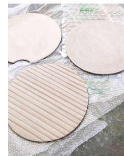
IMG.109 e 110/ Execução das lastras circulares em faiança
