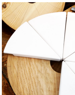
IMG.127/ Acerto das dimensões da peça de madeira aos triângulos em faiança
