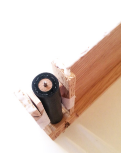
IMG.107/ Colocação dos rolamentos
