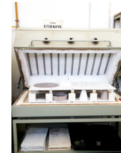
IMG.111/ Enfornagem das peças cerâmicas
