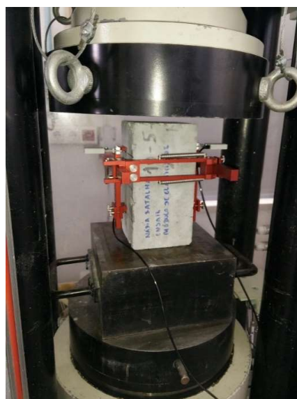
Figura 34 – Instrumentação para medição do módulo de elasticidade
