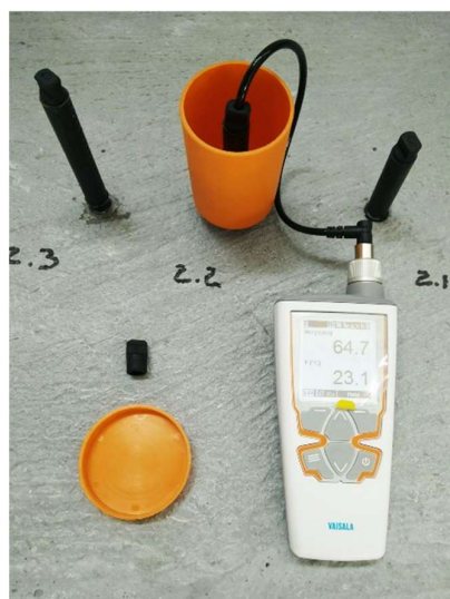
b) Leitura da humidade e temperatura internas do betão no furo 2.2
