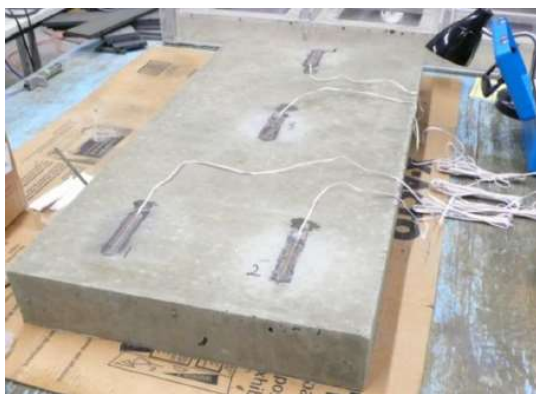
a) Configuração dos extensómetros na laje
