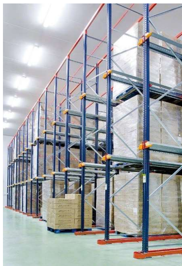
a) Estrutura de estantes apoiadas sobre carris – carga linear ( https://www.mecalux.pt/estantes-paletizacao/estantes-paletizacao-compacta )
