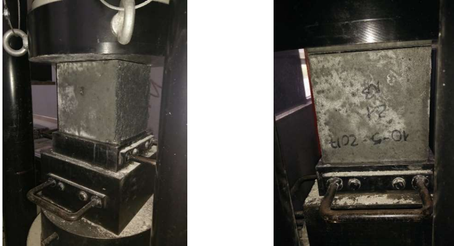
Figura 28 – Ensaio dos provetes à compressão
