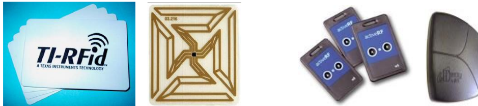
Figura 2.11 - Exemplos de tags RFID: a) passivas; b) ativas 23
