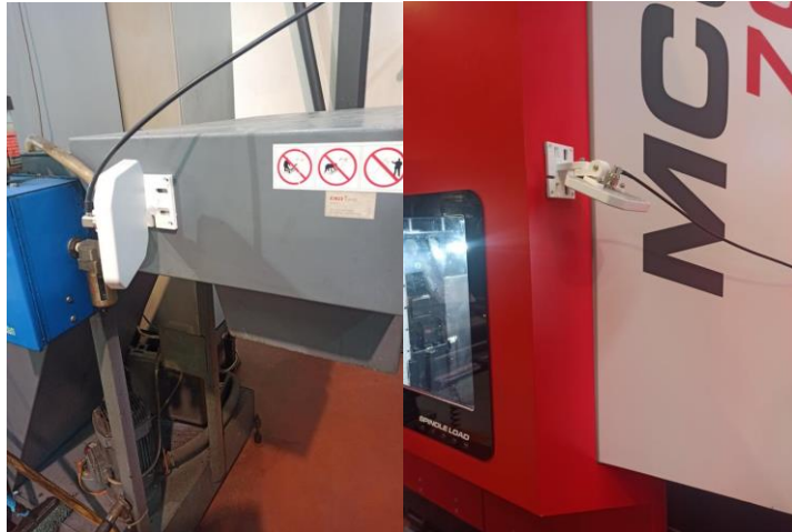
Figura 5.2 - Antenas Zebra junto das máquinas F16 e F32
