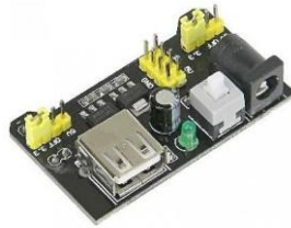
Figura 4.8 - Módulo de alimentação 12
