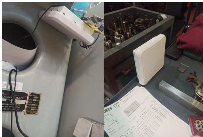
Figura 5.3 - Leitores com o sistema ASL e ASW nas máquinas F33 e F23
