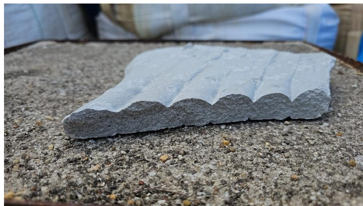
Figura 22 Cordão extrudido com perfil regular e coeso
