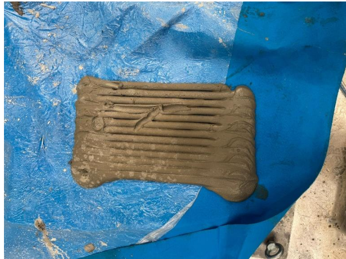
Figura 21 Extrusão contínua da pasta cimentícia em ensaio
