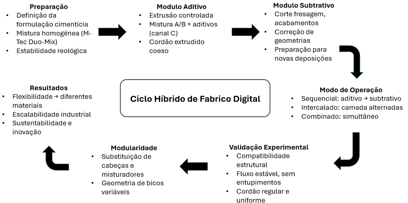
Figura 23 Representação esquemática do ciclo híbrido de fabrico digital
