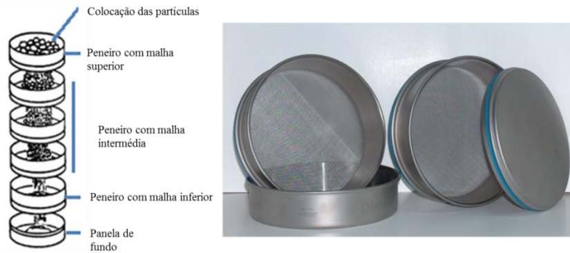
Figura 13 – Separação por granulometria, com a utilização de peneiros manuais
