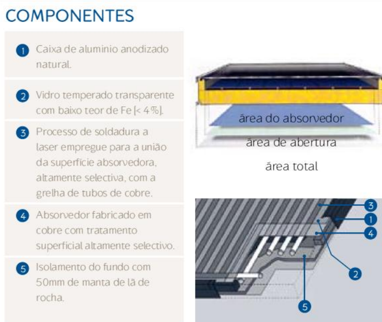
Figura 50 – Componentes de um painel solar AQS [24]
