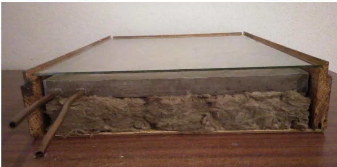
Figura 56 – Construção / Montagem do painel solar AQS.
