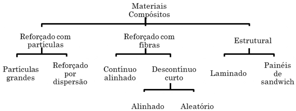
Figura 3 - Classificação dos vários tipos de compósito (adaptado de [10])
