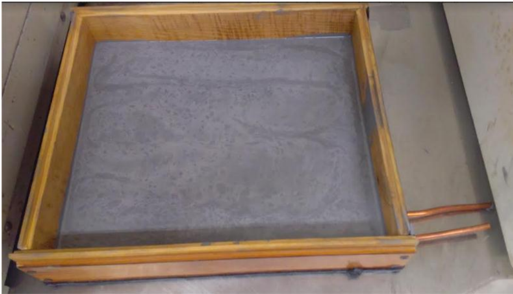
Figura 55 – Construção do absorvedor, vazamento da resina, alumínio e fibra de vidro
