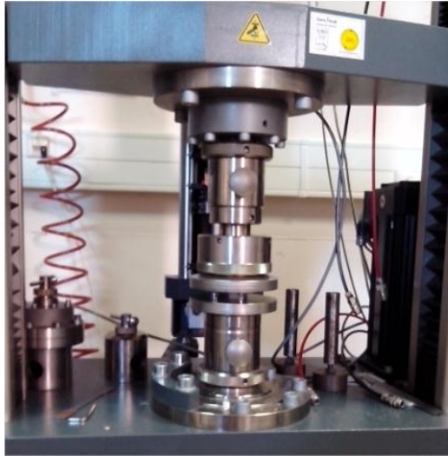
Figura 26 - Ensaio de compressão na máquina ZWICK – Z100
