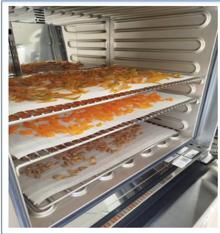
Figura 6: Amostras distribuídas em grelhas numa estufa de convecção forçada Memmert™ a 60 °C, com papel vegetal para evitar adesão.
