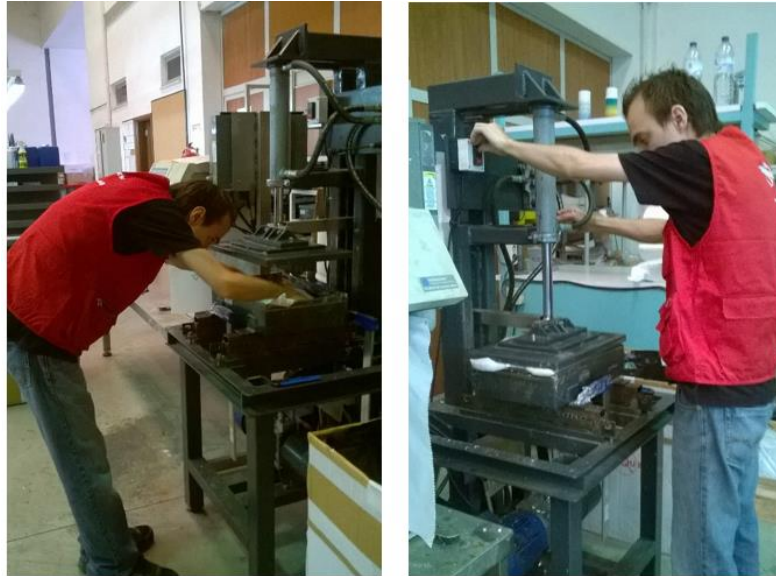
Figura 6 - Eq. 3 – Equipamento de termo formação
