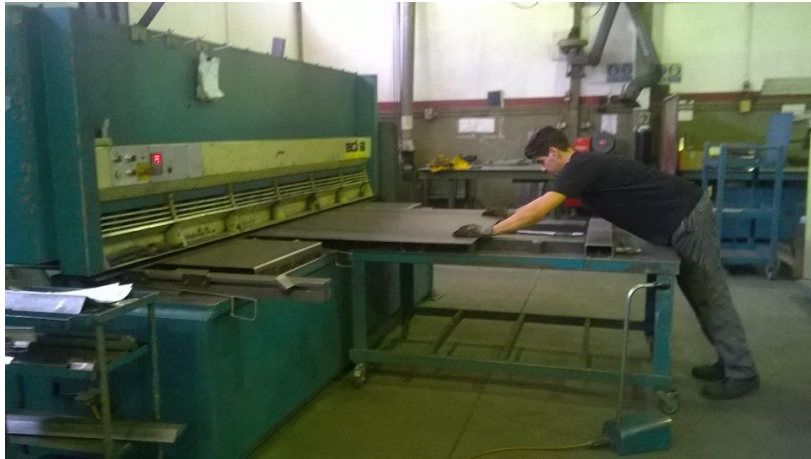
Figura 4- Eq. 1 – Equipamento de corte de chapas
