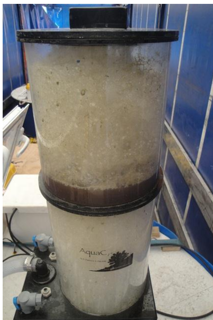
Figura 39. Escumador do tanque 4, durante o transporte das raíais.
