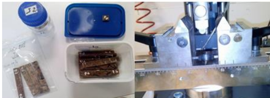
Figura 50 – (Dir.) Provetes prontos ensaios; (Esq.) Sistema mecânico de flexão em 3P (Zwick/Z100).
