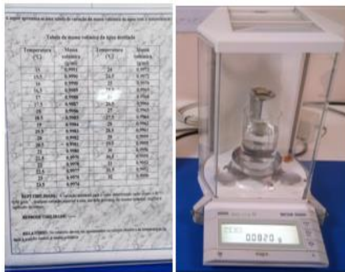
Figura 46 - Balança hidrostática utilizada para determinação das densidades e a tabela de conversão dos valores padrão.
