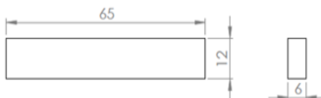
Figura 45 - Geometria e dimensões dos provetes em compósito para os ensaios de flexão em 3 pontos
