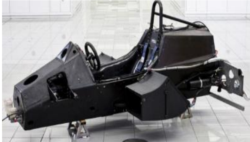
Figura 19 - Monocoque do McLaren MP4/1C, em fibra de carbono; http://www.formula1-dictionary.net/monocoque.html (13/08/2017)
