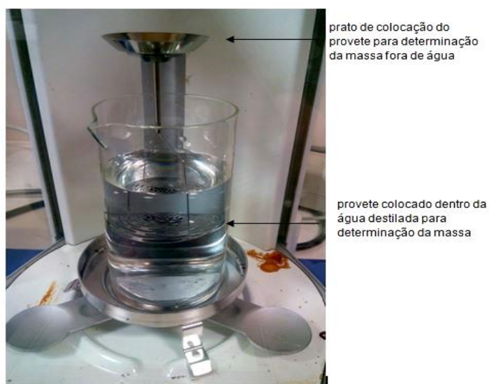
Figura 47 - Balança com os acessórios específicos para facilitar a determinação das densidades
