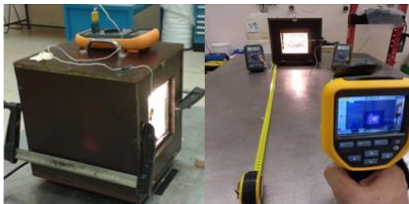
Figura 54 - (Esq.) Câmara de ensaio para os ensaios de condutibilidade térmica; (Dir.) Representação dos procedimentos experimentais considerados nos ensaios de condutibilidade térmica.
