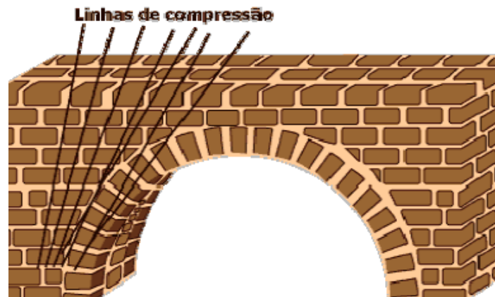
Figura 26. Esquema representativo da força de compressão sobre os apoios dos arcos (Lazzari, 2008) apud Morrissey, 2000
