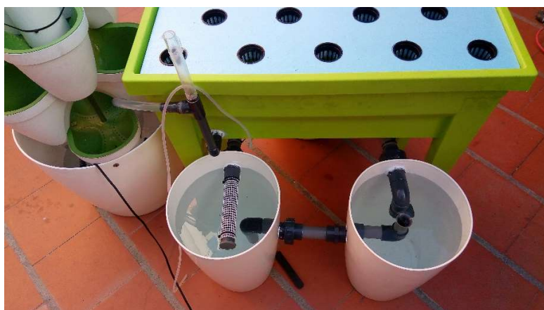
Figura 38 – Filtro de sedimentação e biológico em construção.
