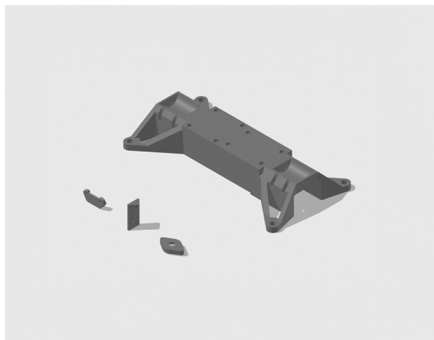
Figura 40_ Representação visual do chassis que alberga os componentes electrónicos do Banco.
