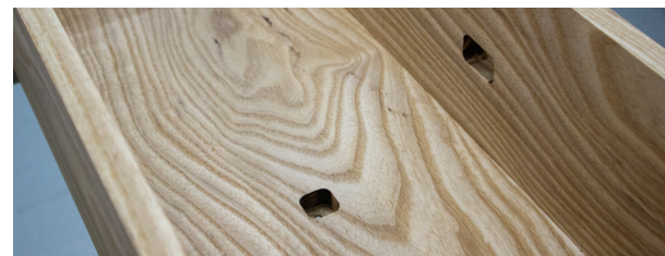
Figura 106_ Baixo relevo de encaixe dos suportes dos sensores da Consola.
