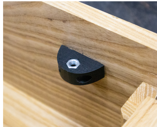
Figura 115_ Ensaio da fixação do suporte da Coluna da perspetiva interior da Consola.
