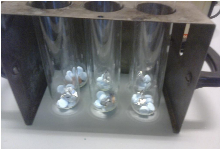
Figura 2.5 – Tubos de digestão contendo as amostras, pastilhas de digestão, água destilada e \text{H}_2\text{SO}_4 (Fonte: própria).
