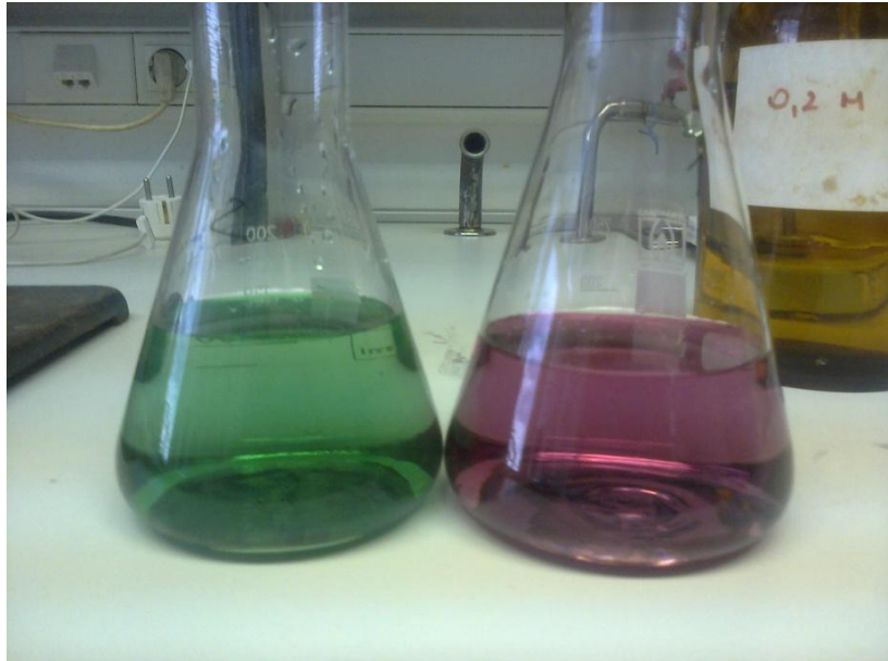
Figura 2.6 – Ponto de viragem: solução após titulação (esquerda) e solução antes da titulação com HCl (direita) (Fonte: própria).
