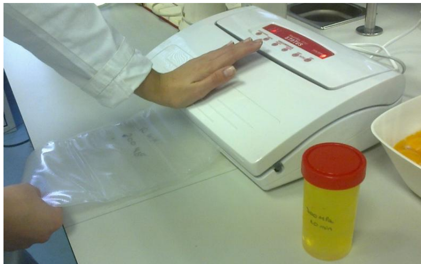
Figura 2.4 – Aplicação de vácuo nas amostras de clara de ovo. (Fonte: própria).
