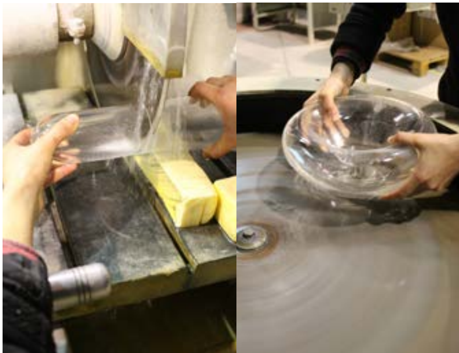
Figura 10/11. Corte e polimento das peças 35
