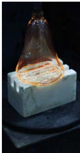
Figura 47. Vidro a ser soprado para cima do molde em pedra mármore
