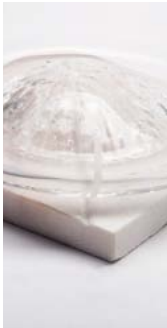
Figura 39. Risco com abrasivo no vidro
