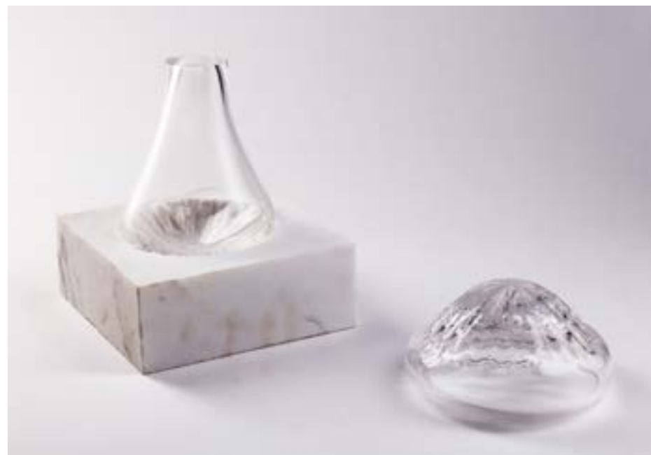
Figura 31. Peças com pedra mármore Figura 32. Vidro soprado duas vezes sobre o mesmo molde em pedra mármore
