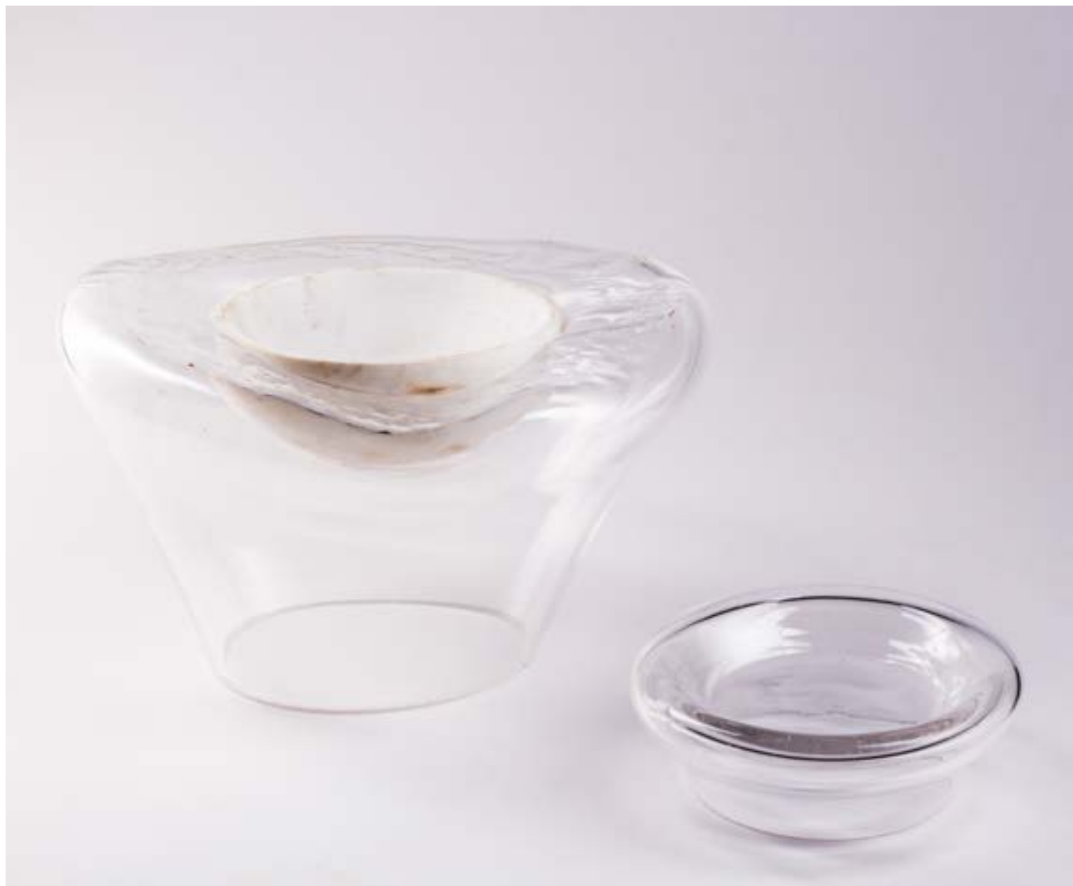
Figura 34. Teste de suspensão do vidro, soprado duas vezes sobre a “taça” em pedra mármore
