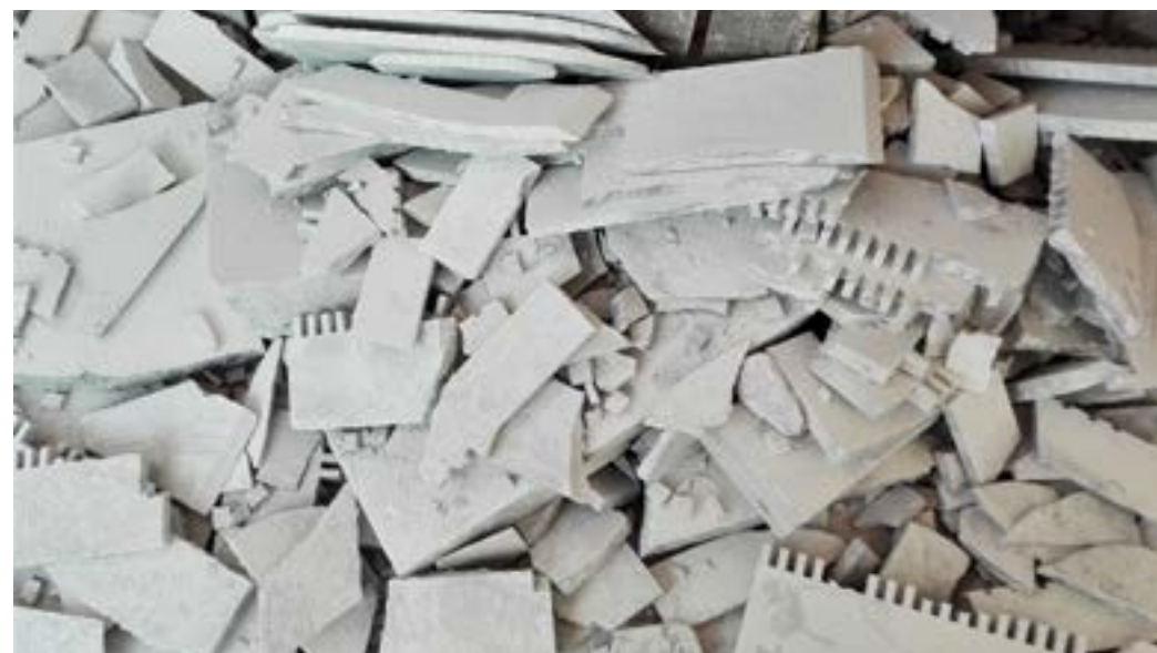
Figura 49. Desperdícios de pedra com as marcas das técnicas utilizadas
