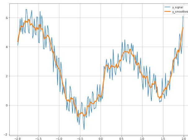
Figura 33 - Exemplo de aplicação do filtro Savitzky-Golay para suavização de um sinal com ruído [38]
