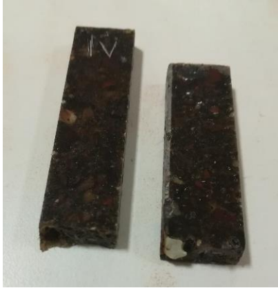
Figura 50 - Rotura de provete causada por impureza
