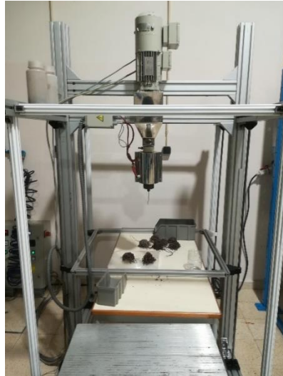
Figura 26 - Equipamento utilizado para realizar a extrusão da mistura de PP com fibras de castanha
