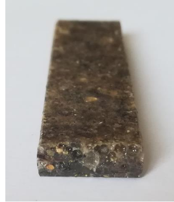
Figura 51 - Bolhas de ar no interior dos provetes
