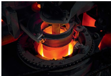
Figura 2.3: Depósito de vidro num alimentador [14].
