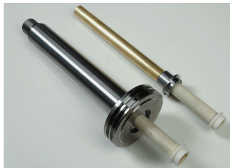
(a) Pistão de prensagem e sensor cerâmico [28].
