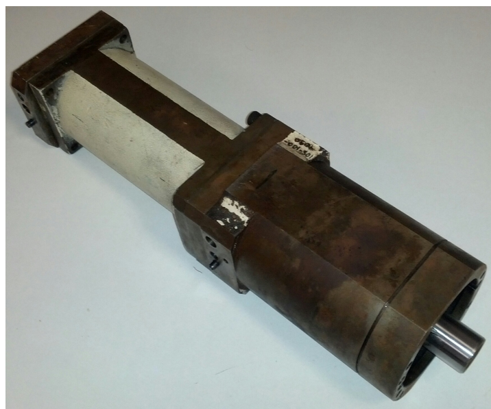
Figura 2.17: Transdutor para peso de gota em máquina IS na BA Vidro, SA.
