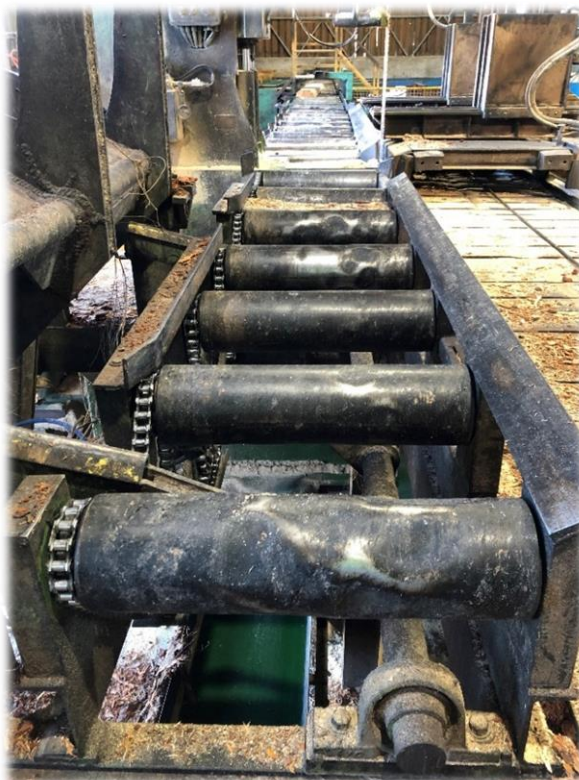
Figura 26 - Deformação dos rolos causada pelo peso dos troncos
