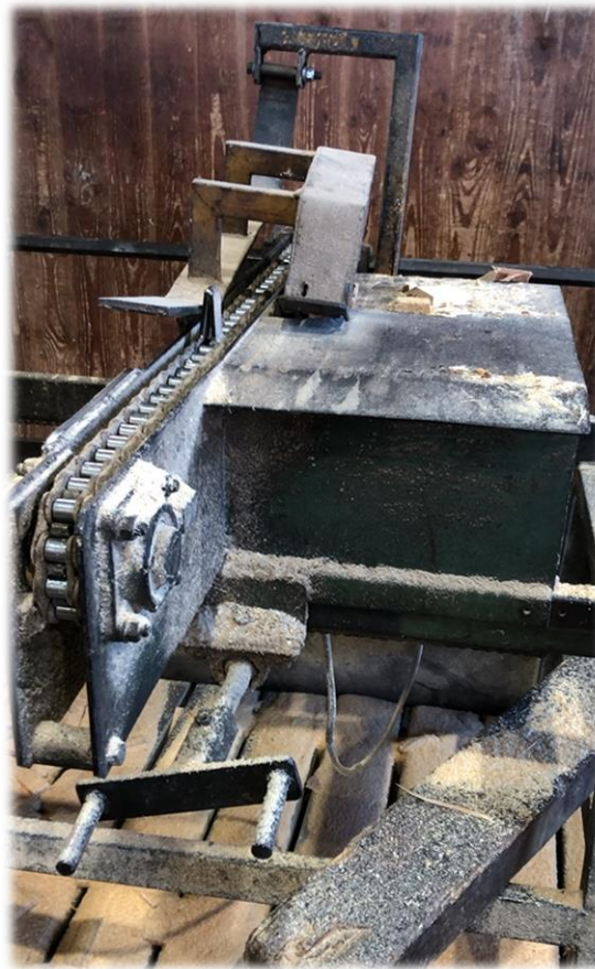
Figura 70 - Serrote de aproveitamento de réguas
