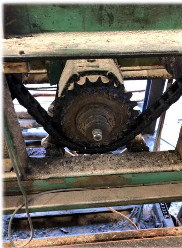
Figura 27 - Desgaste nas correntes e engrenagens
