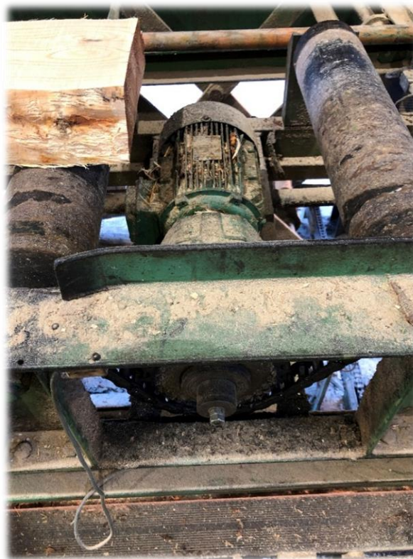
Figura 25 - Acumulação de resíduos nos motores dos transportadores
