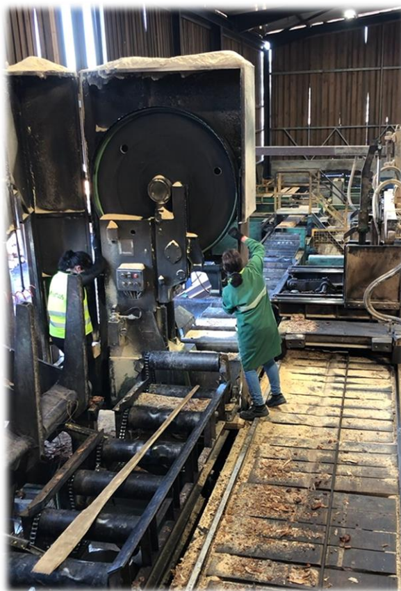
Figura 18 - Troca da folha de corte da serra 1
