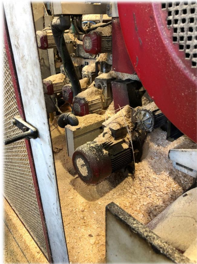
Figura 22 - Acumulação de serradura nos motores da serra 4
