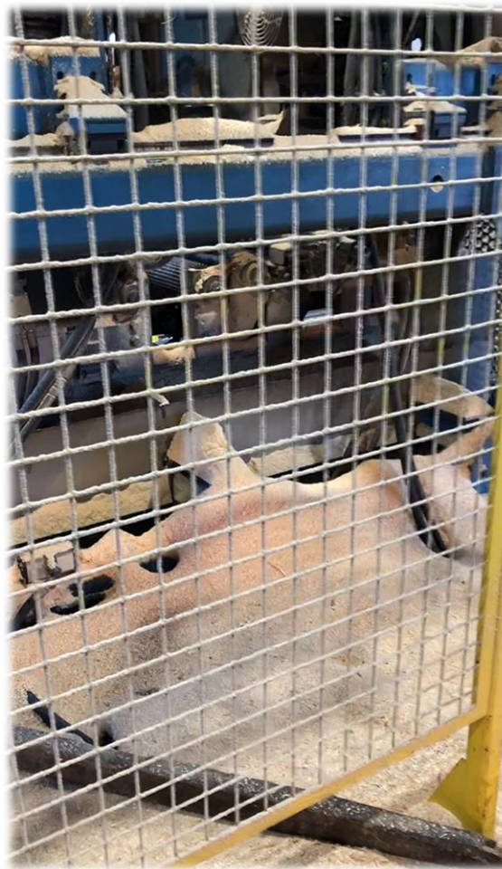
Figura 19 - Acumulação de serradura na serra 2
