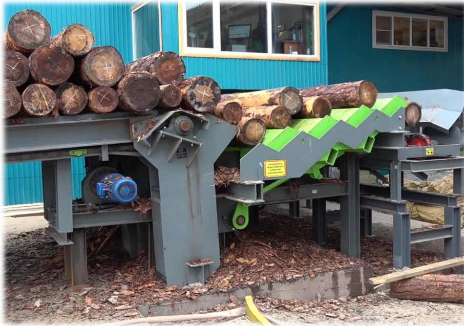
Figura 41 - LSF – Alimentador toro a toro para linhas de serragem de alta velocidade [21]
