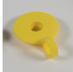
fig. 100 e 101 Impressões 3D em PLA de protótipos. Foram feitos testes de uma barreira para evitar que a vista não foque o redor quando se olha através da lente.
