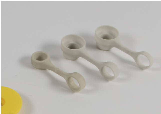
fig. 103 Maquetes dos diferentes protótipos do anel-lupa. Estes modelos foram desenhados em 3D e impressos em resina. Foi dada uma distância entre o anel e a lente, para haver mais espaço de aproximação sem bater na mão.
