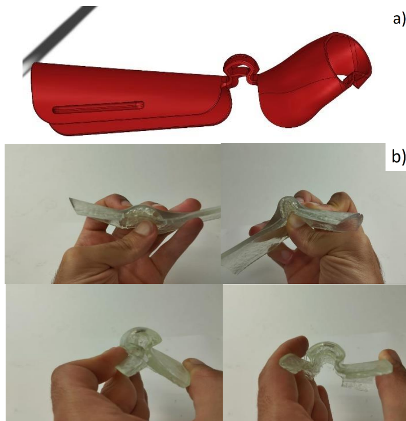
Figura 7 - Modelagem teste a) e impressão teste b) do mecanismo conector - Fonte Própria.
