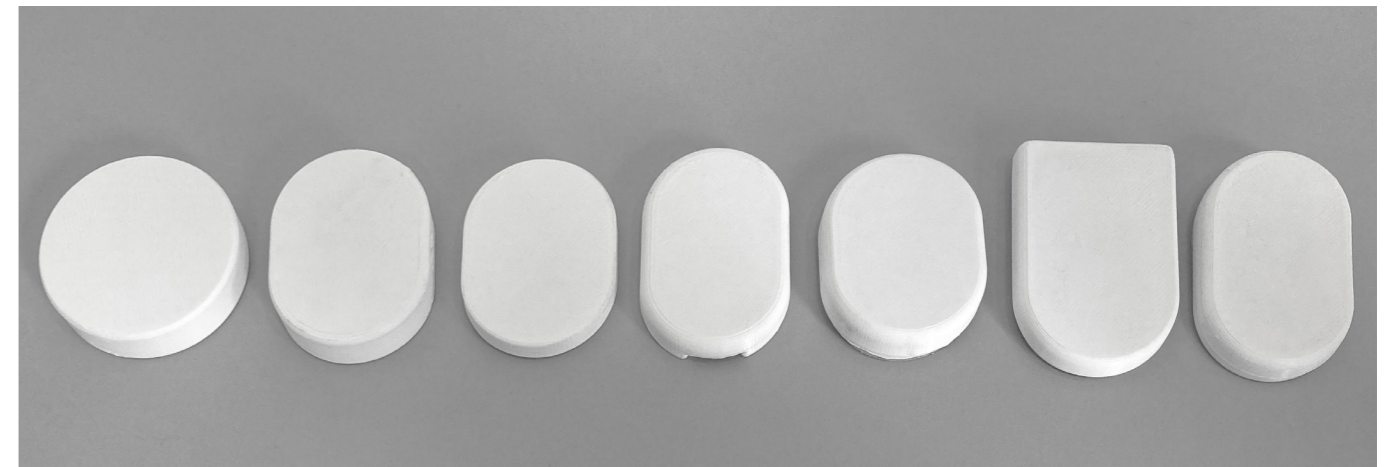
Impressões 3D de vários formatos para a cápsula do sensor e destacável para remoção do adesivo da cápsula.
