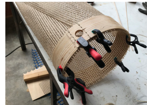
Fig. 52. Assemblagem do aro de madeira
