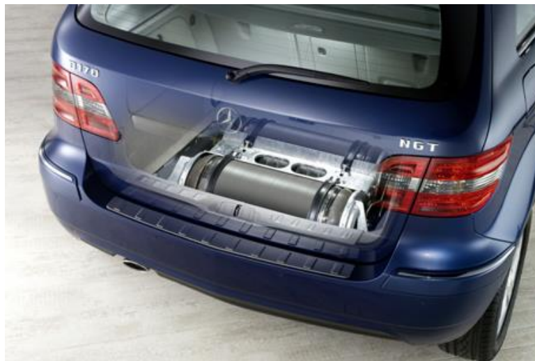
Figura 17-Armazenamento de GNC em veículos atualmente (23).
