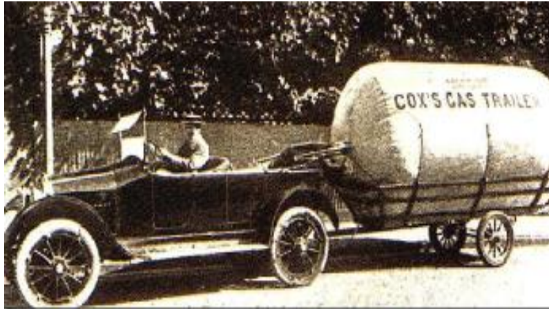
Figura 16- Armazenamento de GNC em veículos antigos (22).
