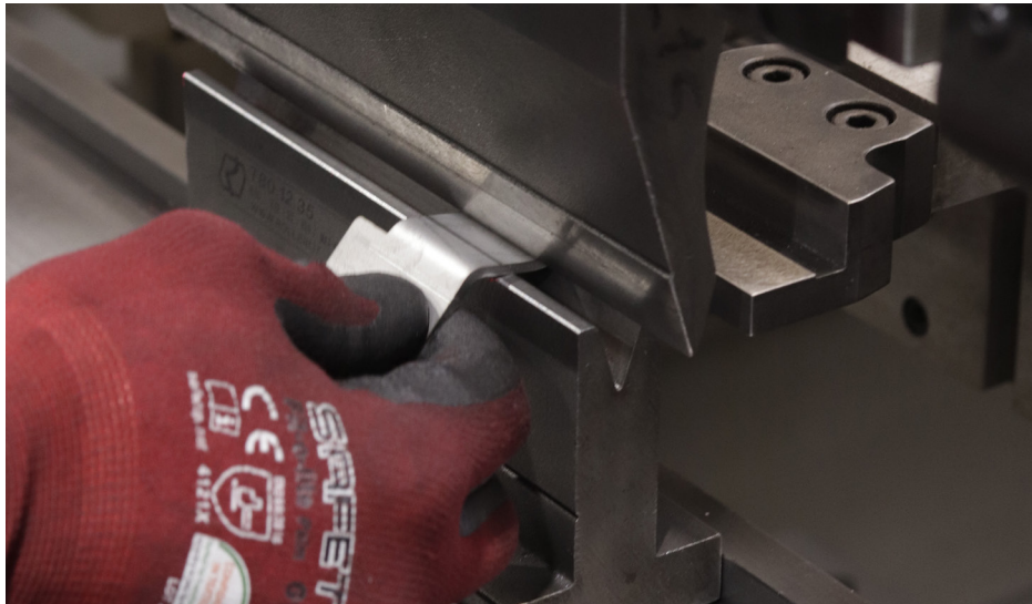
fig.163- Quinagem do elemento Suporte de Módulos
