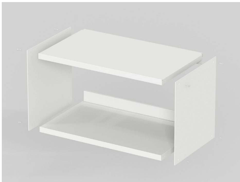
fig.101- Visualização explodida dos elementos do armário
