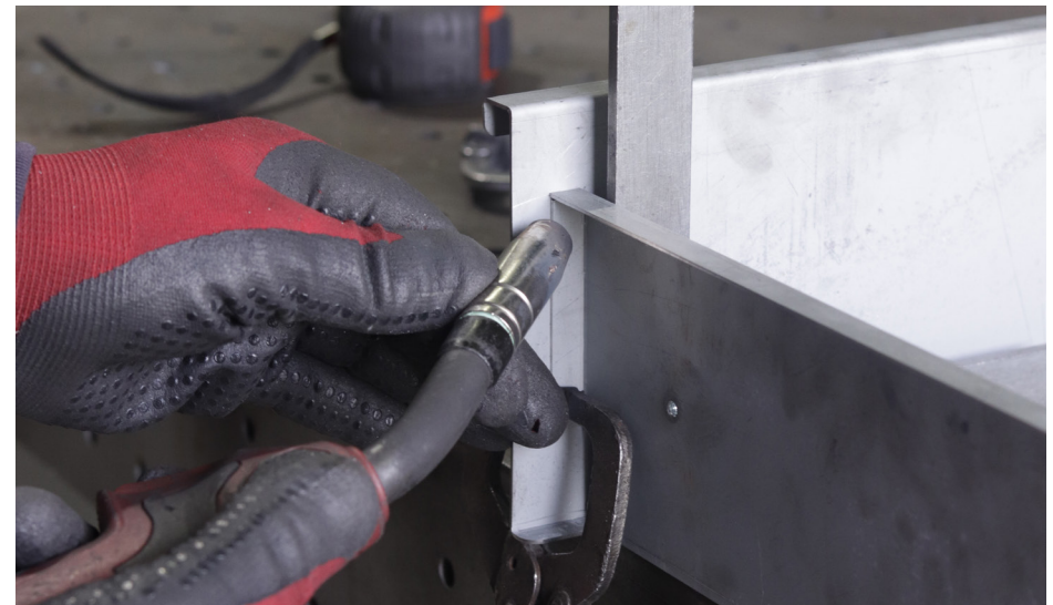
fig.172- Soldadura da lateral do gaveta com a frente
