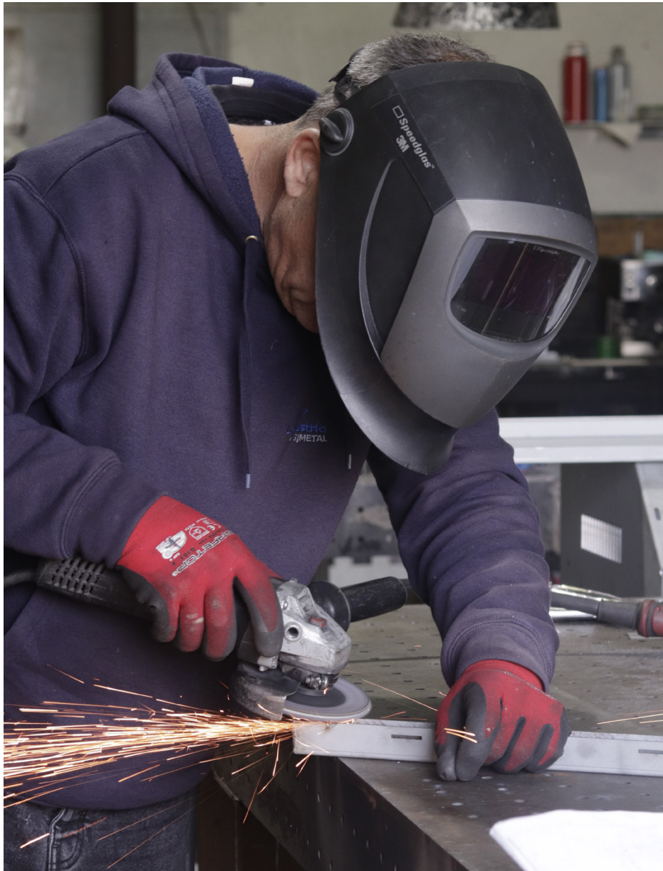
fig.174- Retificação da soldadura no perfil
