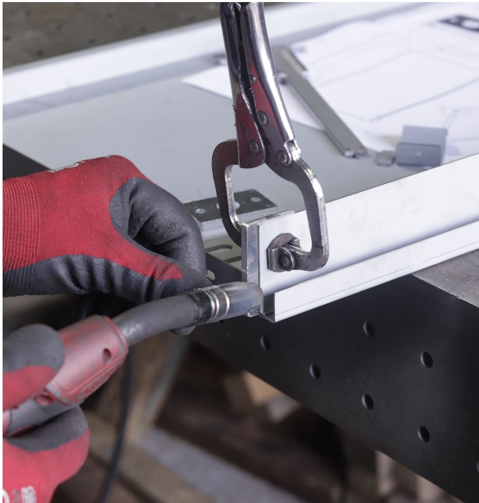
fig.171- Soldadura do batente na base do armário
