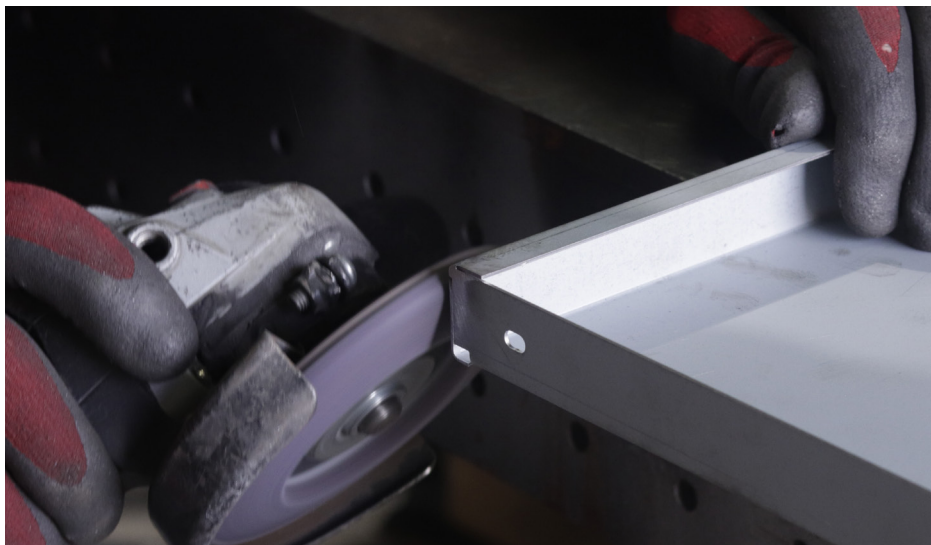
fig.177- Base do armário com soldadura retificada
