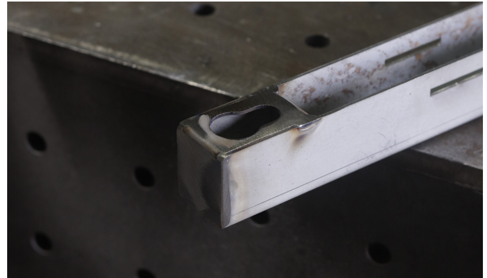
fig.175- Perfil com soldadura retificada
