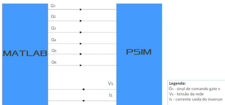
Figura 6.1 Exemplo de quadro operacional de cooperação entre MATLAB e PSIM
