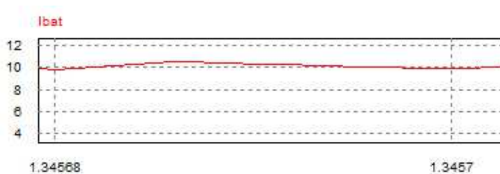
Figura 6.11 O sinal de corrente da primeira proposta: modo G2V
