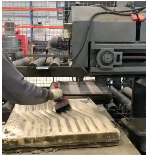
Figura 19 - Aplicação de Desmoldante
