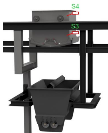
Figura 55 - Sensores de Nível no Balde Doseador
