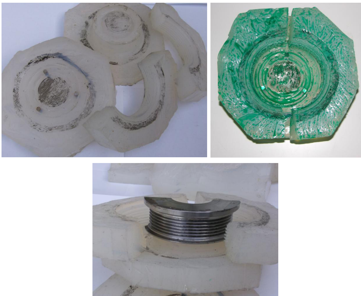
Figura 6.8. Molde e postigos moldantes em silicone.
