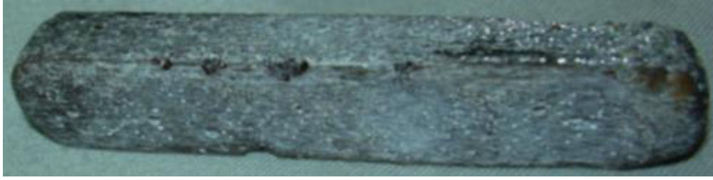
Figura 3.10. Provette em material compósito com 50% de microesferas metálicas.
