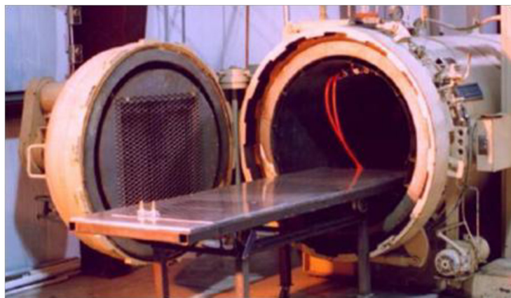
Figura 2.10. Representação esquemática da moldação em autoclave.
