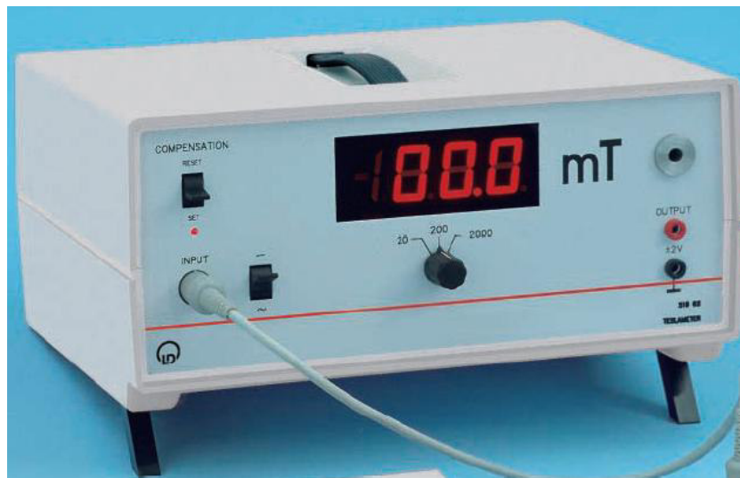
Figura 3.8. Equipamento Teslameter para medição de campos magnéticos.
