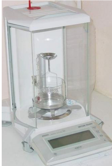
Figura 3.4. Balança eletrônica de precisão usada na determinação das densidades.
