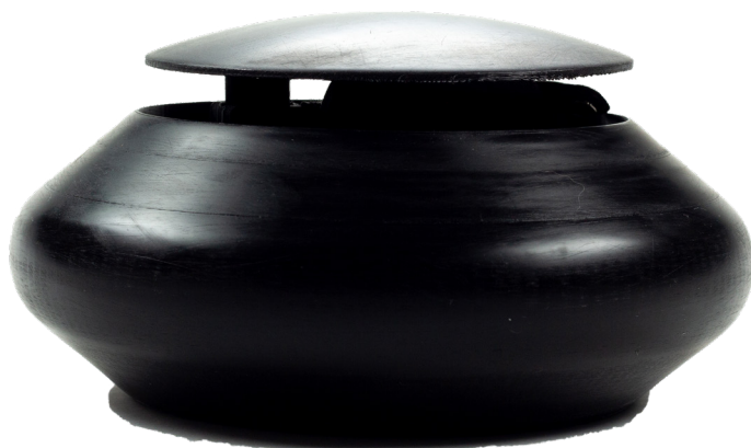
Figura 62 - Primeiro protótipo finalizado em PLA preto;
