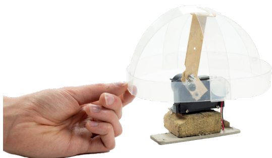
Figura 45 - Mecanismo interno do peluche com adaptações de modo a funcionar como protótipo
