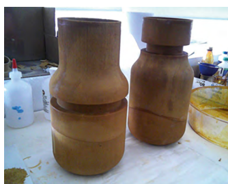
3. Elementos impressos evidenciando as zonas de união bem ajustadas
