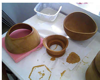
2. Elementos impressos infiltrados c/ goma-laca
