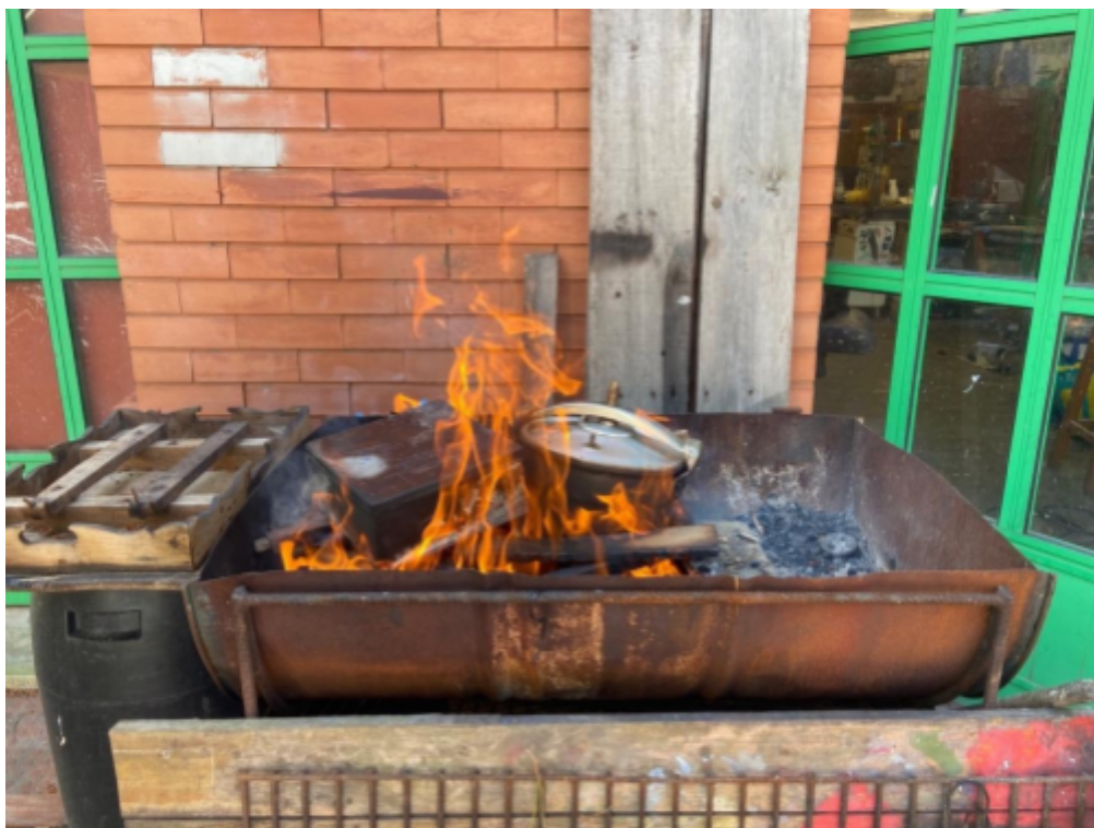
Figura 35 – Produção de carvão a partir da carbonização de galhos de choupo, 2023.
