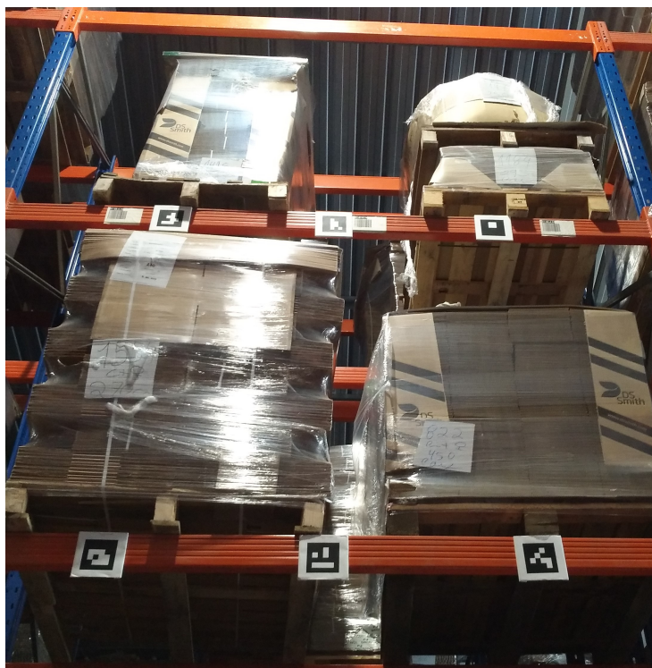
Figura 46: Vista com os marcadores ao longo das prateleiras do armazém da empresa Matceramica.
