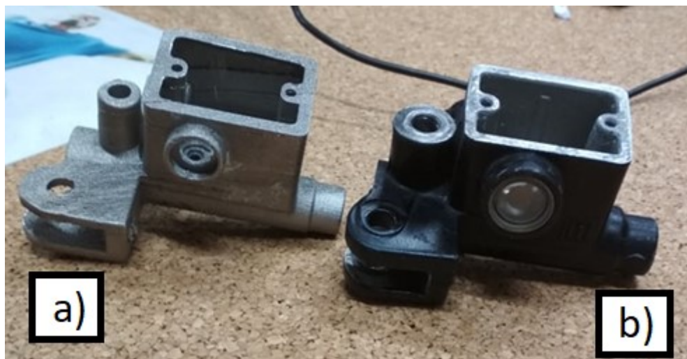
Figura 60 - Bomba produzida por SLM e em Aço H13 (a) e bomba original em Alumínio (b)
