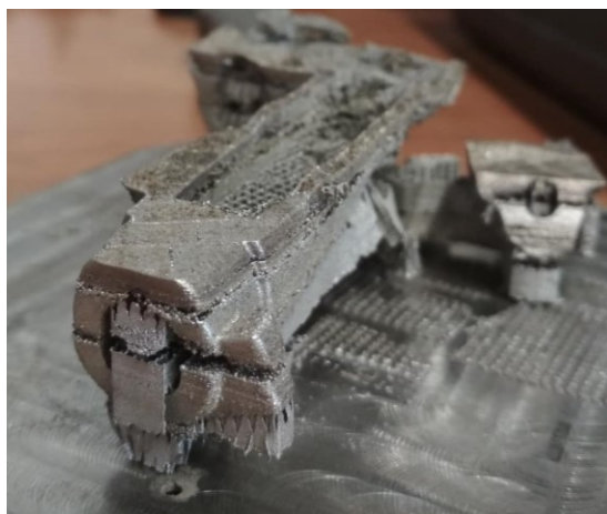
Figura 57 - Levantamento de camadas devido às constantes paragens do recoater
