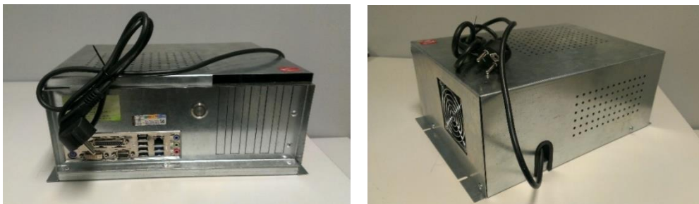
Figura 29 - Montagem final da unidade do computador
