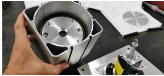
Figura 49- Montagem do vedante da mesa de adição
