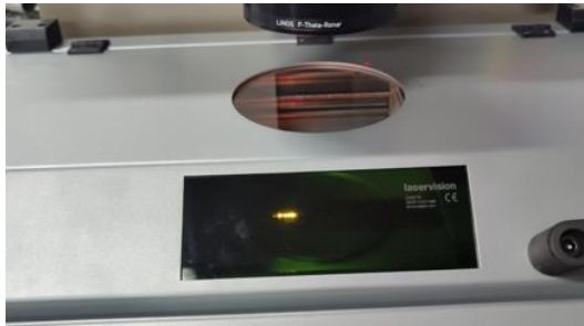
Figura 82 - Fusão de material na presença de atmosfera inerte
