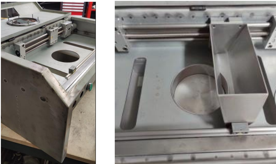
Figura 58 - Assemblagem da cuba à mesa de trabalho
