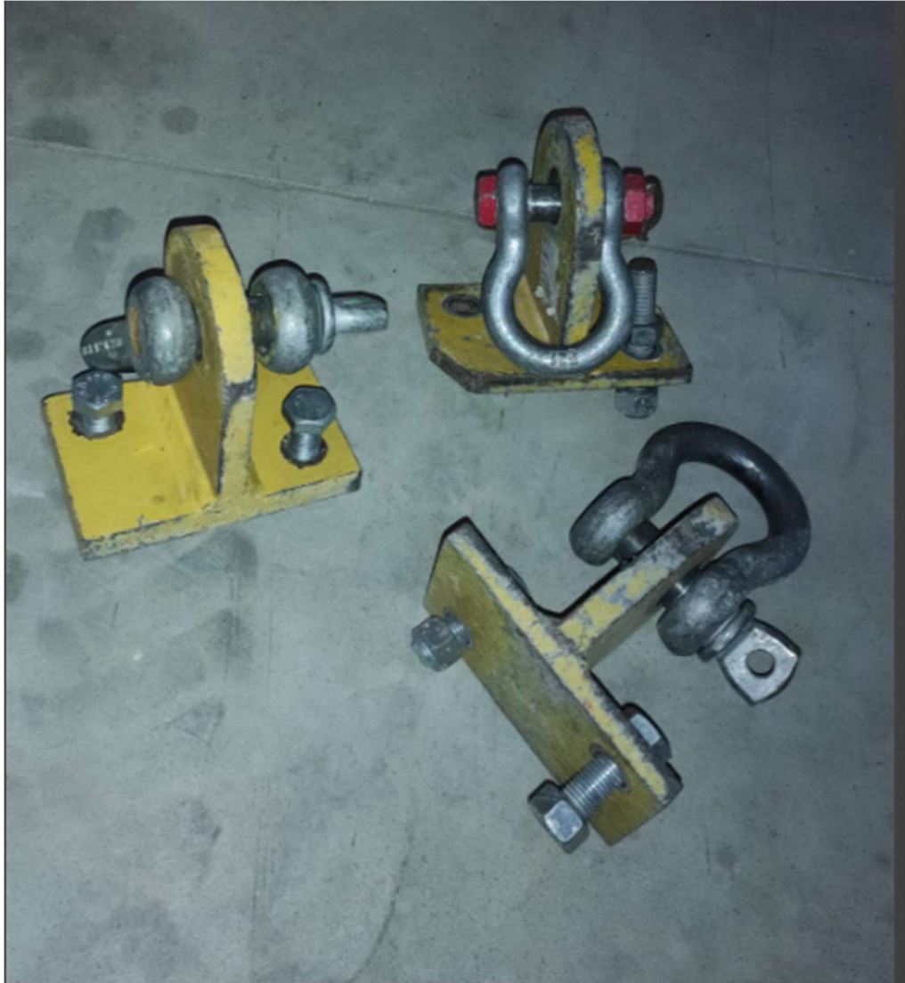
Figura 29 - Manilha parafusada a viga (Fonte: Autor)
