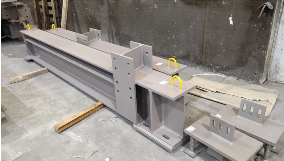
Figura 27 - Viga com primário (Fonte: Autor)
