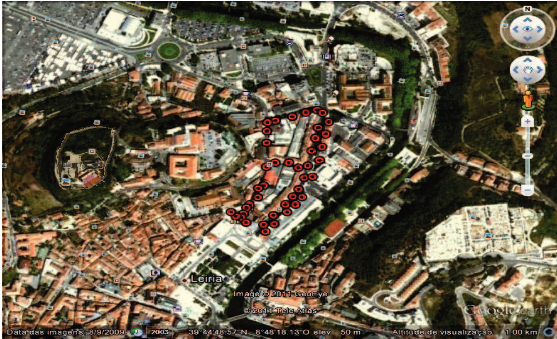
Figura 26 - Esquema da distribuição das luminárias do PT 947 IP (Imagem retirada do Geoportal)
