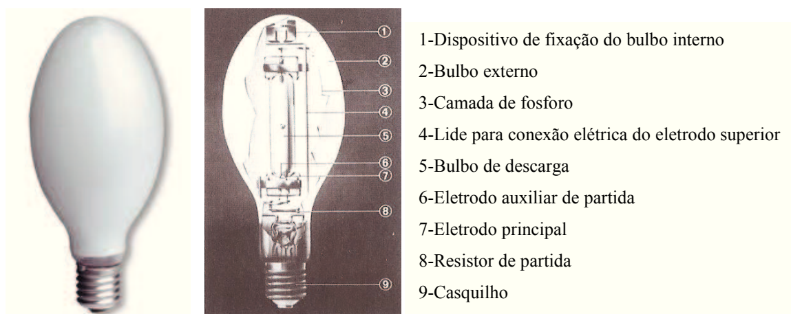
Figura 1 - Lâmpada de vapor de mercúrio e os seus componentes
