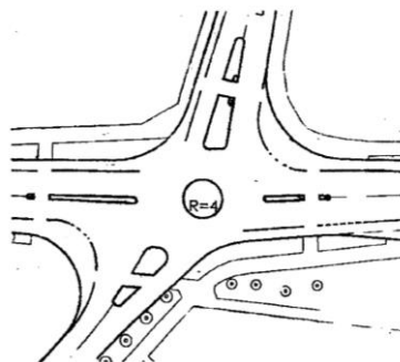
Figura 3-5: Ángulo de entrada defectuoso. [32]
