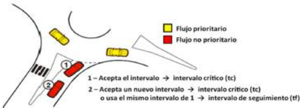
Figura 2-27: Funcionamiento de una rotonda con la teoría de aceptación de intervalos. [27]
