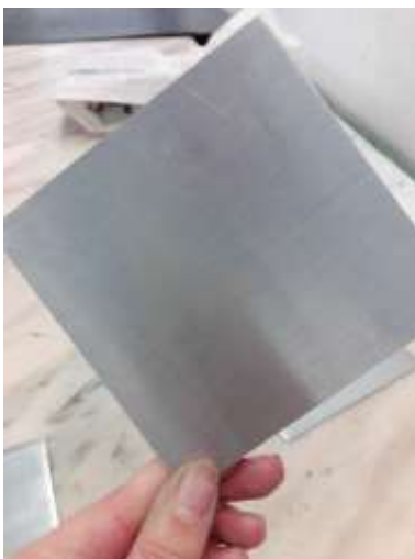
Figura 23 - Evolução do processo de lixar e polir a chapa de zinco (Sara Santos 2018).
