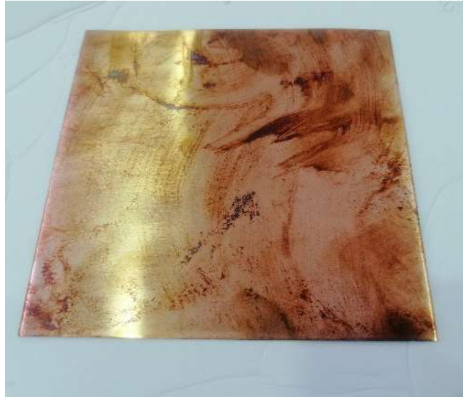
Figura 46 – Chapa de cobre manchada/oxidada de álcool (Sara Santos 2019)
